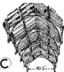
**С** ПРОСТЫЙШІЙ ВИДЪ КРЫШИ СЪ АРОЧНЫМИ ФЕРМАМИ •
